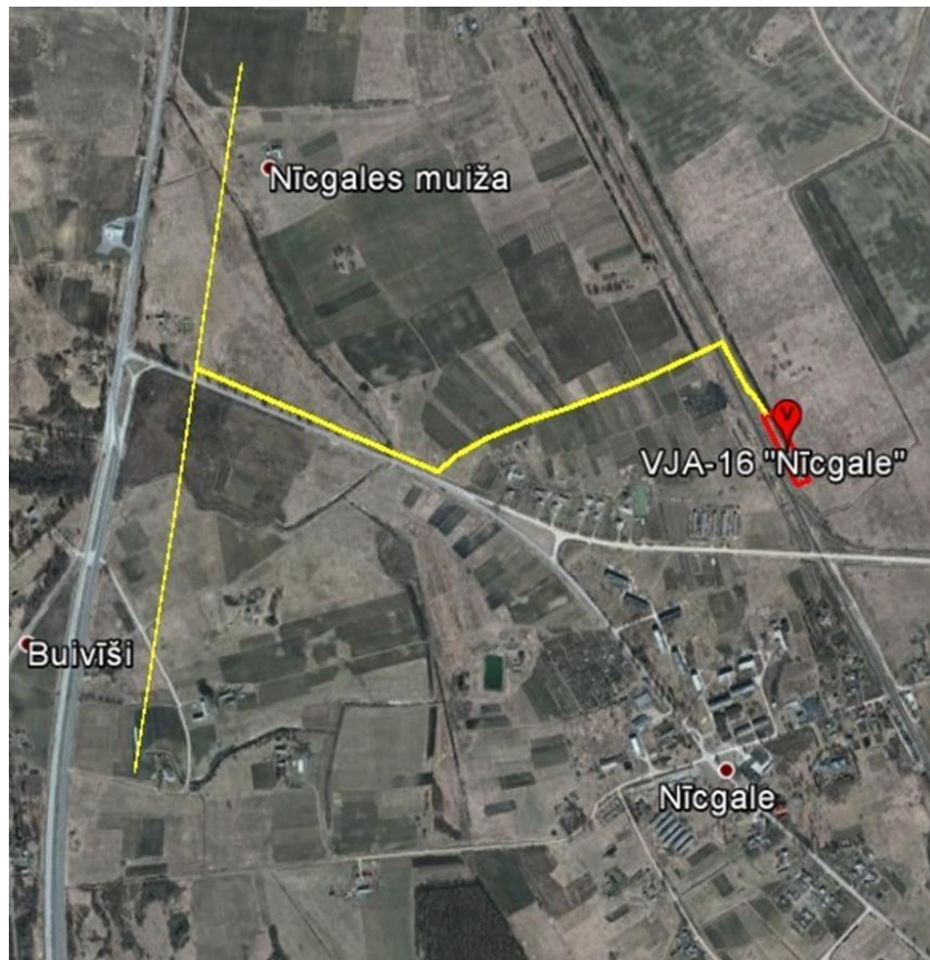
53.attēls VJA-16 Nīcgale pieslēgums pie elektrotīkla
